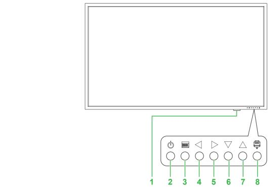
Indicateur d'état LED / Capteur IR (pour la télécommande) 5 Bouton Volume plus / Droite
