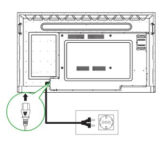
Coloque el conmutador de alimentación en la posición de encendido y, a continuación, presione el botón de alimentación de la pantalla o del mando a distancia.
